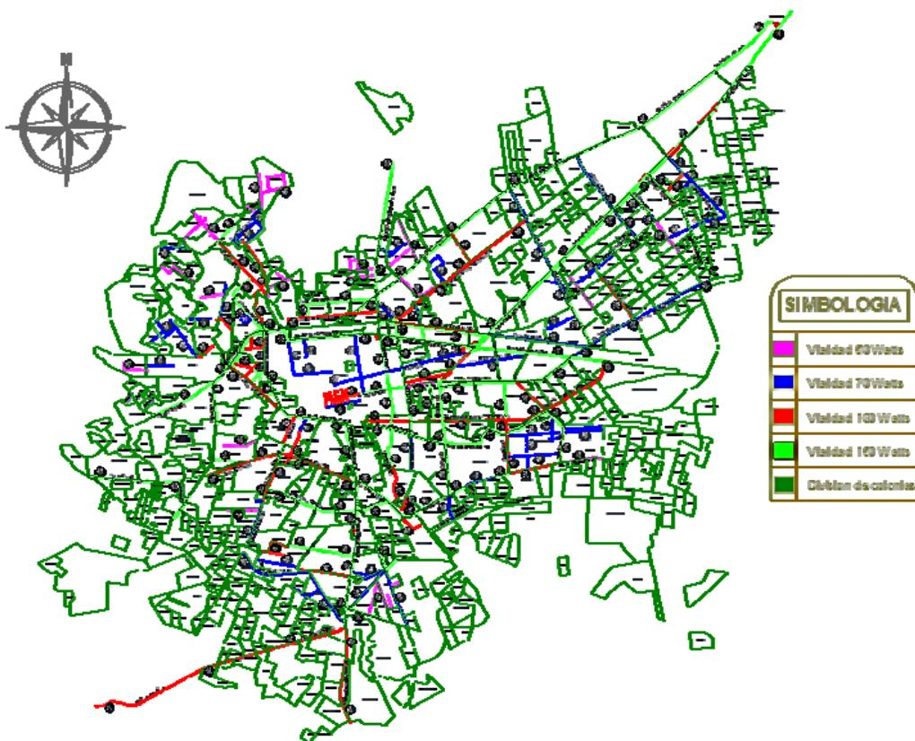
**Recorte de las vialidades con detalles de niveles de iluminación y potencia a instalar**
